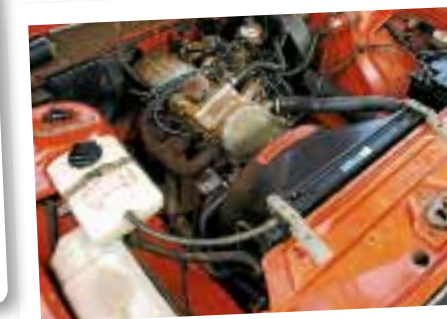
Det är rent och snyggt runt B21-motorn på 100 hk.
